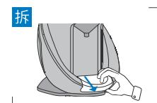
手指捏拿托盘前端，向后上方自然拉出(托盘上盖可拆卸)
