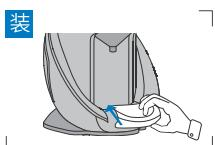
(若托盘上盖打开请先合上托盘上盖)手指捏拿托盘前端，对着卡槽向前推送。
