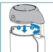
3. 将搅拌杯盖子盖上,将盖子向右旋转与搅拌杯卡扣扣紧
