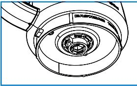
4. 检查刀片组件,上下方向无松动,左右方向可旋转,表示组装成功
