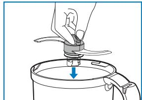
2.捏住刀组,由搅拌杯内部的底座圆孔
