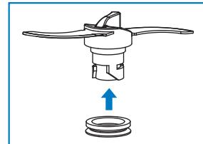
1.刀片防水圈装配至刀架
