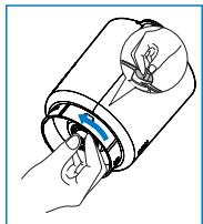
3.将刀托向OPEN方向旋
