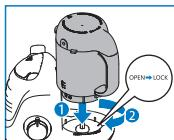
4、将搅拌杯放入主机杯槽，
