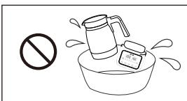
请勿将壶体及加热底座浸入水中清洗,以免造成产品损坏。
